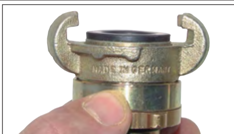
Vorgeschaubte Dichtung - Verbindung ist dicht.
